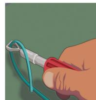
**e.** Corte o excesso do cordão de solda com o cabo exato e o auxílio de uma lâmina externa quadrada.
