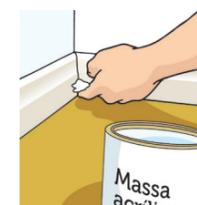
**e.** Faça os acabamentos das emendas com massa acrílica ou a própria cola de rodapé. Remova o excesso com um pano úmido e limpo.
