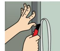
**35.4.4.** Antes de aplicar a peça seguinte, corte os excessos com um estilete e use espátula para pressionar bem as bordas contra a parede.
