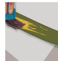
**23.3.** Aplique adesivo de duplo contato sem toluol nas paredes e no verso do rodapé (que deve estar limpo e livre de pó). Aguarde 15 minutos e cole o rodapé encostando a parte superior junto à linha e depois encaixe a parte de baixo.
