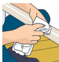
**b.** Limpe bem cada barra e parede onde o rodapé será instalado.
