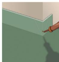
**d.** Após a secagem do adesivo, fresar e soldar os ângulos de 45°.
