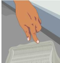
**g.** Verifique o tack do adesivo após 15 minutos da aplicação. Se houver pega, mas os dedos ficarem limpos, inicie a aplicação do produto. Se o adesivo ainda estiver úmido e a instalação for iniciada, poderão ocorrer bolhas ou descolamento.
