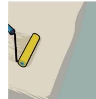
**33.3.** Aplique o adesivo Tackfix® de tack permanente com rolo de lã, aguarde o tack e inicie a colocação das placas/régua, de acordo com a paginação do projeto ou da embalagem. **IMPORTANTE:** se o tempo de tack não for aguardado e a instalação for iniciada com o adesivo ainda úmido, o carpete será colado de forma permanente, independente do tipo de base (piso elevado ou contrapiso).
