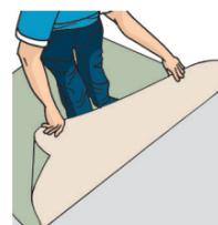
**17.3.** Desdobre a manta para cima do adesivo trabalhando na direção da parede e respeitando o eixo previamente marcado.
