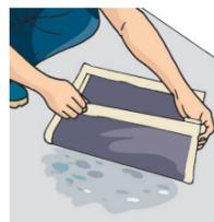
**Método manual (plástico):** coloque pedaços de plástico (mínimo 40x40cm) em diversos pontos do contrapiso. Prenda toda a borda do plástico com fita adesiva e aguarde 24 horas. Se o plástico "transpirar" ou se o contrapiso ficar mais escuro nessa área, significa que a água ainda está evaporando e, portanto, o contrapiso está úmido. Deixe o local ventilado e repita o teste alguns dias depois. Este teste não é preciso.
