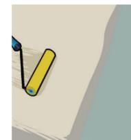
**31.3.** Se a instalação for de um piso autoportante colado, aplique o adesivo Tackfix® de tack permanente com rolo de lã, aguarde o tack e inicie a colocação das placas/ régua, invertendo o sentido do desenho, se necessário.
