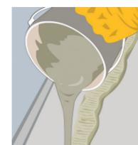
a. Começando do eixo marcado previamente e utilizando uma desempenadeira dentada A4, espalhe o adesivo seguindo as informações de rendimento para cada tipo de produto.
