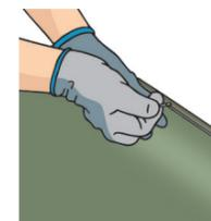
**e.** Depois de instalar as mantas, espalhe o adesivo de duplo contato na área de colagem da parede e por cima do suporte curvo (exceto se estiver instalando mantas heterogêneas). Aguarde o tack e molde a manta encaixando a borda na aba do arremate de rodapé com o auxílio de uma chave de fenda.
