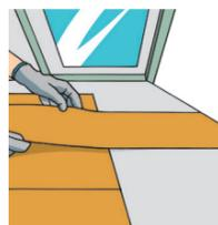
**25.5.** Distribua régulas soltas sobre as últimas coladas (próximas às paredes), encoste-as na parede e com um estilete copie os recortes. Dobre a régua para trás, corte a sobra com o estilete golfinho e encaixe no espaço correto. Repita este procedimento ao longo de todas as paredes.
