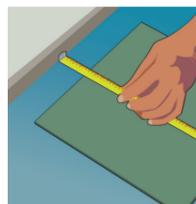
**33.1.** Caso esteja instalando o carpete em placas ou régua sobre piso elevado, recomendamos que as dimensões do produto sejam sempre diferentes do tamanho dos módulos do piso elevado. Isso faz com que as juntas do piso e da base do piso elevado fiquem desencontradas, evitando possíveis degraus nas emendas.
