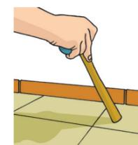
**6.2. Cerâmico:** com juntas inferiores a 5mm. Antes da aplicação da Tarkomassa® Autonivelante é necessário aplicar uma demão do Tarkoprimer®. Caso a opção seja pela Tarkomassa® Fastplan, não é necessário o uso do Tarkoprimer®.
