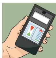
**Método digital:** utilizando um medidor por radiofrequência, coloque o aparelho em uma parte plana do contrapiso ou parede. A interpretação da leitura deve seguir a tabela inscrita no aparelho
