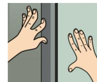
**35.4.5.** Caso o padrão do produto não seja modular, instale a segunda peça sobrepondo pelo menos 3cm sobre a borda da primeira peça. Pressione bem o revestimento contra a parede para retirar todo o ar. Com o auxílio de uma régua de metal, corte a longitudinal sobreposta dos produtos, de cima para baixo. Remova as faixas que sobraram e feche bem as juntas, pressionando suavemente com a espátula. Avalie a sobreposição caso o padrão tenha módulo.
